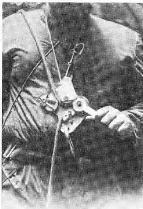
Tako se napelje vrv skozi napravo TaC za spuščanje. Zapreti je treba samo še varovalno ploščico in blokirati jeziček. Foto J. Kalan
