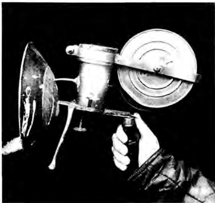
Slika 1: Bengalična luč – mehanizem je odvijal magnezijev trak, ki je izgoreval pred zaslonom z močno belo svetlobo. (Martel, Les Amibes . Paris, 1894)
