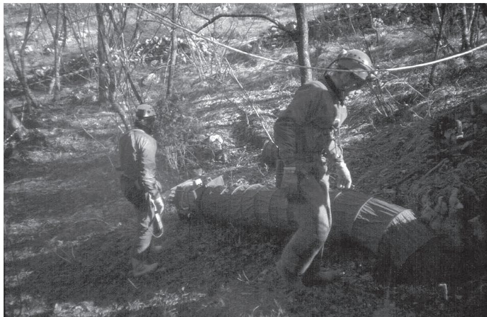
Slika 3. »Dimovlek« za odvajanje izpušnih plinov vrtalnikov ter minerskih plinov. Foto: Jaka Jakofčič.
