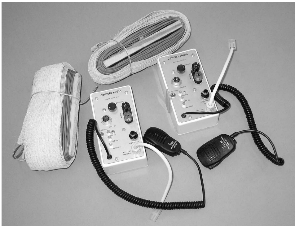
Slika 1: Sistem za brezžično komunikacijo sestavljata dva identična aparata s priključnima dipolnima antenama, narejenima iz traku električnega pastirja in nerjaveče jeklene izolirane žice.
