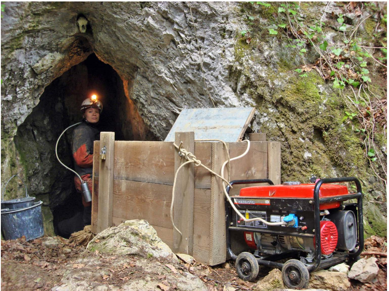
Slika 19. Motor z notranjim izgorevanjem je postavljen na površju, v jamo pa je potegnjel kabel.
