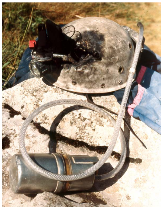
Slika 25. Čelada se je zaradi snetja gumijaste cevke z inštalacije karbidne svetilke vnela in povsem zgorela.
