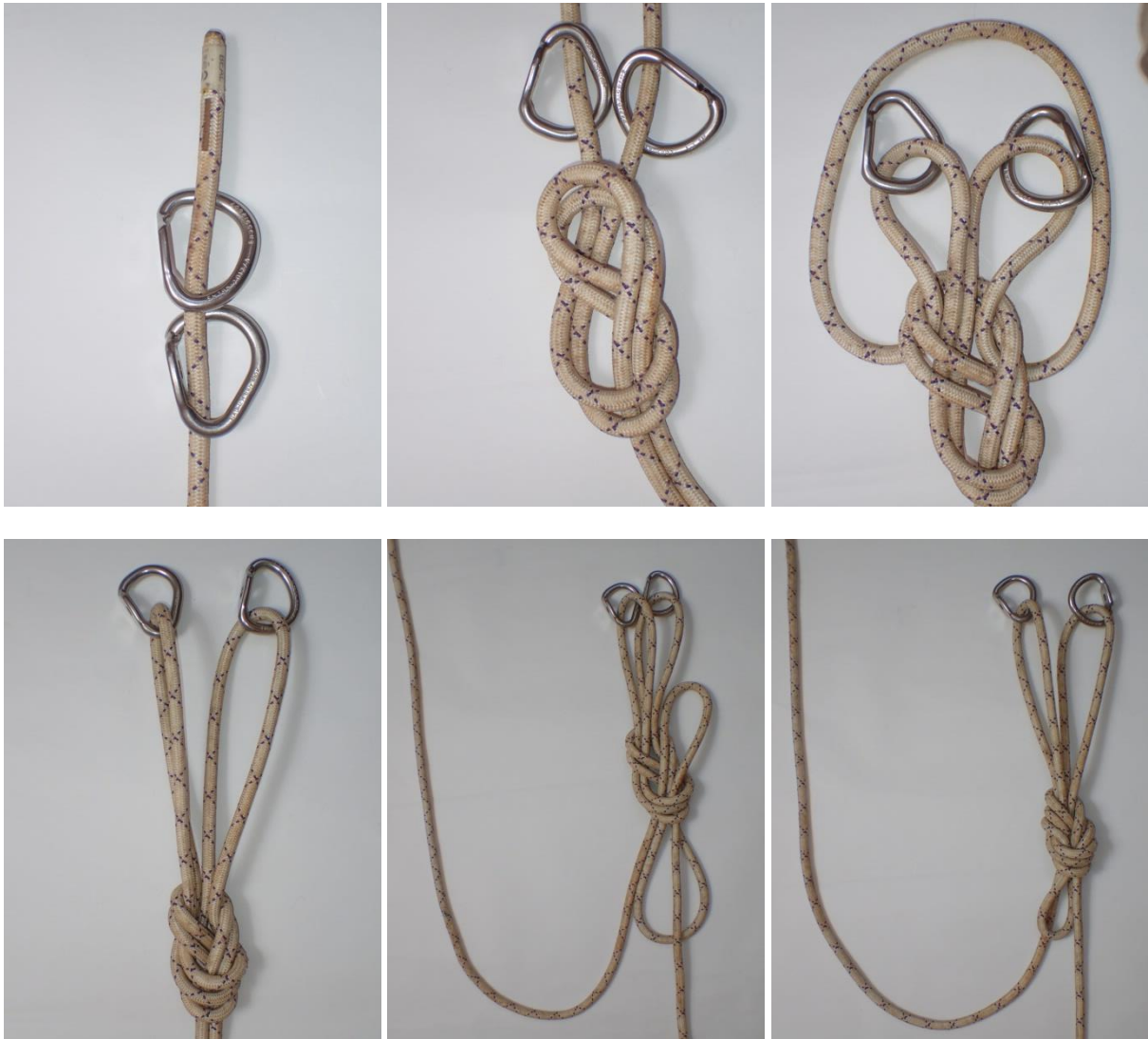
Slika 2: Postopek izdelave dodatne vpenjalne točke iz opremljevalne vrvi na dvojnem sidrišču.
