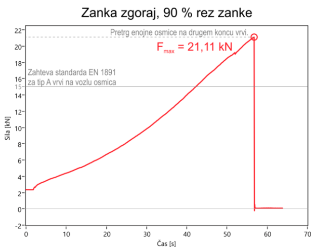
Slika 7: Osmica z dvojno zanko zaključena zgoraj, delni rez povezovalne zanke. Graf sile v odvisnosti od časa ter stanje pred in po preizkusu.
