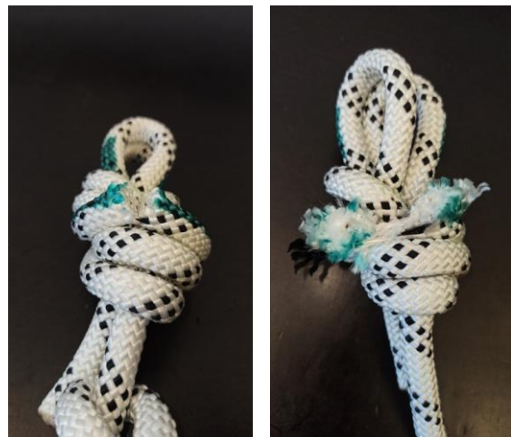
Slika 7: Osmica z dvojno zanko zaključena zgoraj, delni rez povezovalne zanke. Graf sile v odvisnosti od časa ter stanje pred in po preizkusu.
